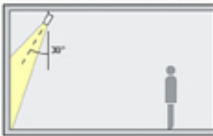
Ángulo de inclinación 30° para iluminación vertical
